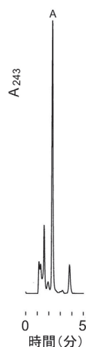
図2 アスコルビン酸のHPLC分析 マイクロトマト抽出液に含まれるアスコルビン酸について、HPLC分析を行った。Aはアスコルビン酸のピークを示す。
