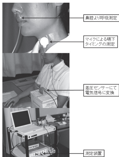
図1 差圧センサーによる呼吸と食物の嚥下タイミング測定
