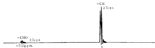
図4 純アセトアルデヒドのNMRスペクトル
